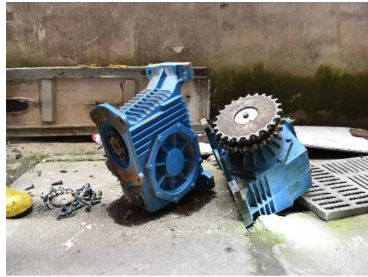
图 20 拆卸的扶梯减速箱
