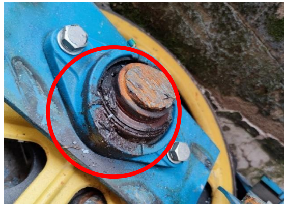
图 21 拆下的自动扶梯零部件布满油污
