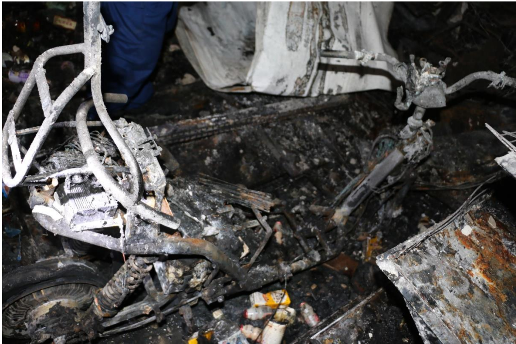
图 6 事故店铺内二轮电动自行车过火后图
