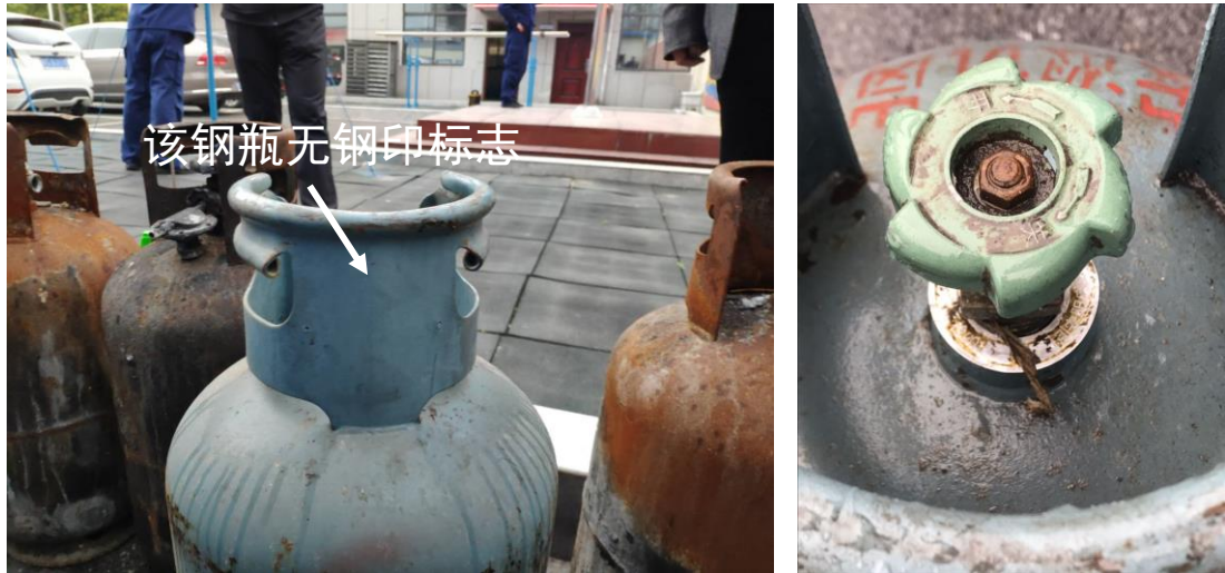
图 9 现场搜出的标识为“安液仇岗站”液化气瓶无钢印标志
