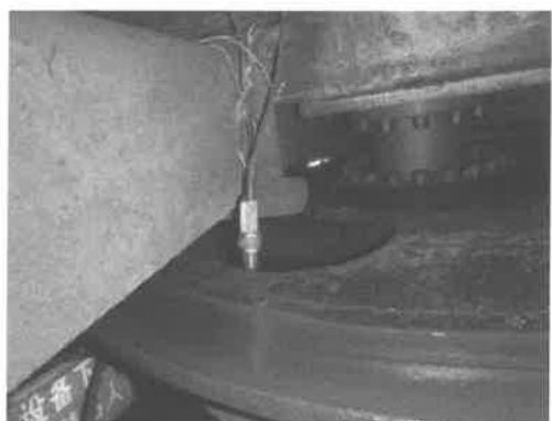
图 2-4 保护探头未有效固定
